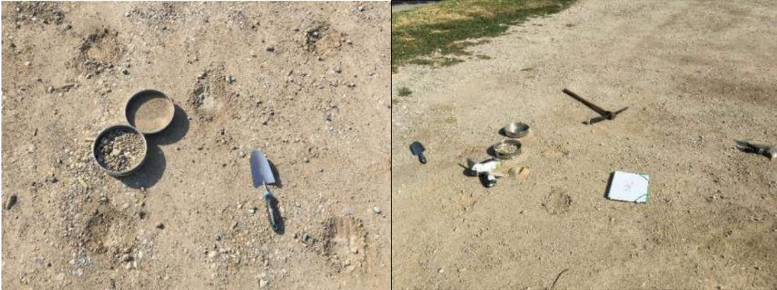
Illustration 39 - Photographies des mesures pXRF (prises unitaires, composite, tamisage et mesure)
